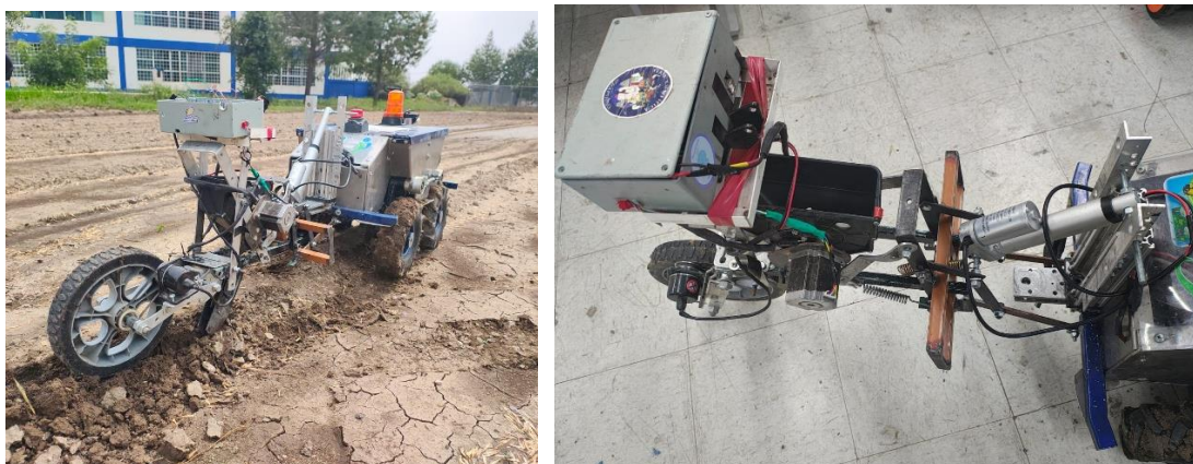
Figura 3. Cuerpo de siembra con enganche de tercer punto al robot agricultor.
